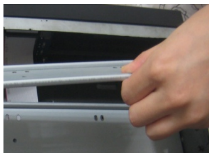
Рис. 1.1.2. Демонтаж верхней панели крепления HDD
