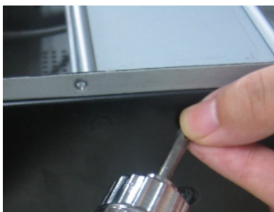
Рис. 1.1.1. Демонтаж верхней панели крепления HDD
