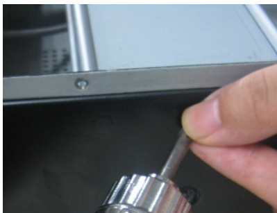
Рис. 1.2.1. Демонтаж верхней панели крепления HDD
