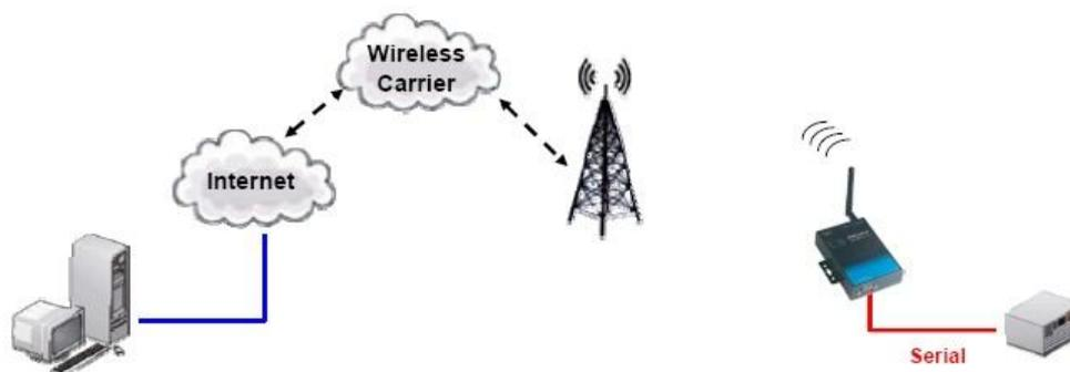
Последовательные порты устройств OnCell G3111/G3151/G3211/G3251 поддерживают стандарты RS-232/422/485. По сути, IP-шлюзы OnCell – это мини-компьютеры с процессором и поддержкой протоколов стека TCP/IP для двунаправленного обмена данными между последовательными устройствами и IP-сетями. Используя OnCell G3111/G3151/G3211/G3251, можно получать диспетчерский доступ к оборудованию, осуществлять управление и производить настройку оборудования удаленно (через глобальную сеть) из любой точки мира.
