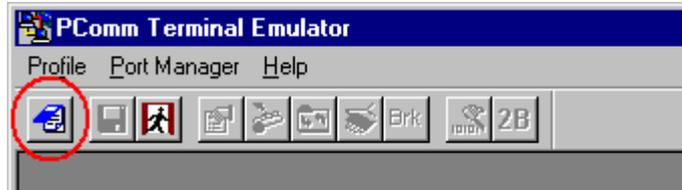
4. Откроется окно выбора свойств Property. Зайдите на вкладку **Communication Parameters** и выберите COM-порт, к которому подключено устройство (COM1 в примере). Установите параметры: **115200, 8, N, 1**.
