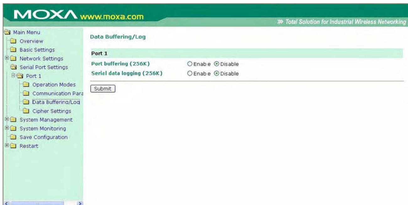
OnCell G3111/G3151/G3211/G3251 имеет возможность буферизации данных последовательного порта для предотвращения потери данных при отсутствии Ethernet-соединения. Буферизация может применяться в режимах Real COM, Secure Real COM, Reverse Real COM, Secure Reverse Real COM, RFC2217, , Secure TCP Server, TCP Client, Secure TCP Client и SMS Tunnel. Для других режимов настройки буферизации неприменимы.
