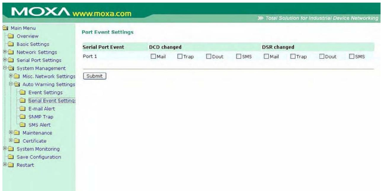
На странице настройки событий по последовательным портам можно настроить оповещения сетевого администратора об изменениях сигналов DCD и DSR последовательных портов. Для различных событий доступны различные функции автооповещения, как показано на рисунке выше. **Mail:** Электронная почта отправляется на указанный e-mail. **Trap:** это отправка SNMP-прерываний. **Dout** – функция связана с изменением состояния релейного выхода. **SMS:** функция отправки сообщения на указанный телефонный номер.
